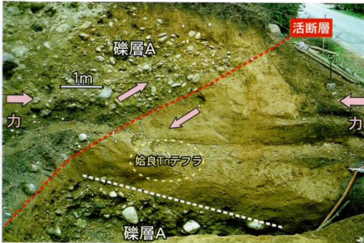
道路面より下へ2m余掘り下げたところ。 礫層Aと同じ礫層が確認できた
